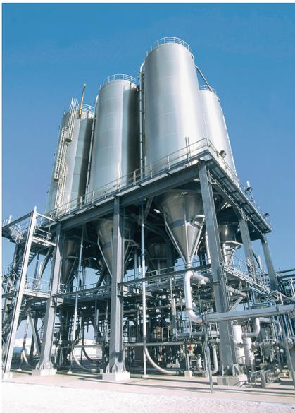
Mischsilos sind eine wartungs- und verschleißarme Alternative zu mechanischen Mixern. © Zeppelin Systems
